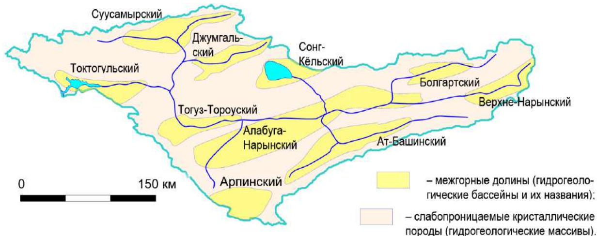
Рисунок III.1.28. Гидрогеологическое строение бассейна р. Нарын [Гидрологическая..., 2001].
