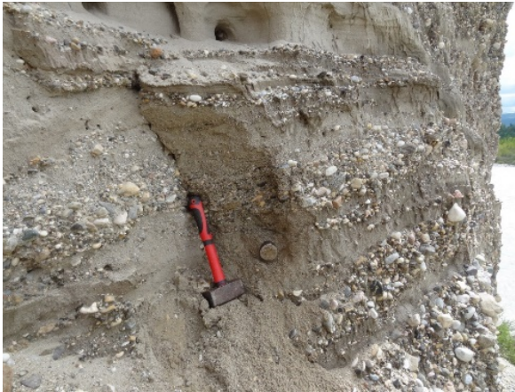
Рис. 5.5. Пример отбора образца из песчаного прослоя пачки 4 на OSL датирование.
