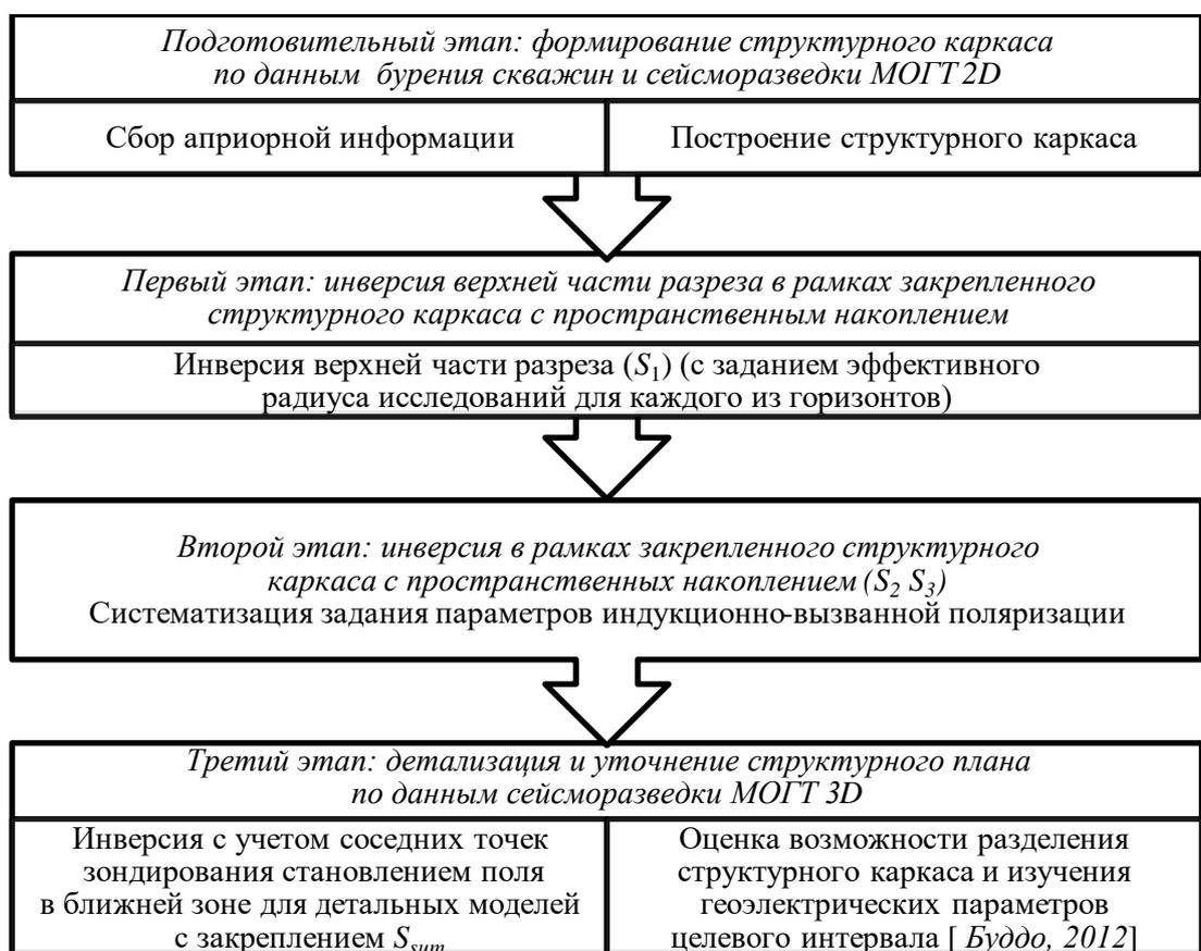
Рис. 1.10 – Схема последовательности инверсии данных зондирования становлением поля в ближней зоне, основанная на практических данных
