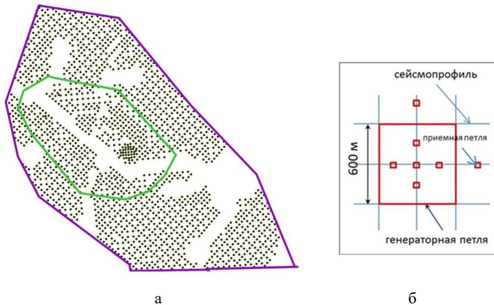
Рис. 3.22 – Схема точек зондирования становлением поля в ближней зоне (а) и схема установки (б)
