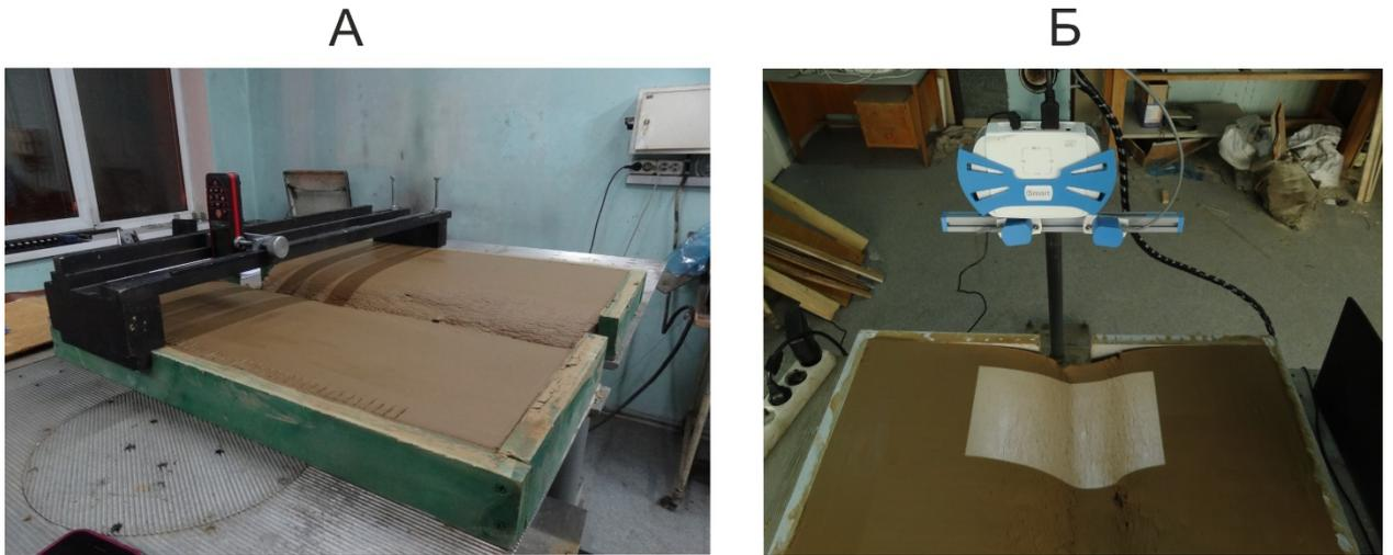
Рис. 3.2. Два способа измерения рельефа поверхности экспериментального образца: лазерным дальномером (А) и 3D сканером (Б).
