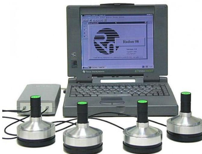
Рис. 2–1. Общий вид радиометра «Камера-1».
