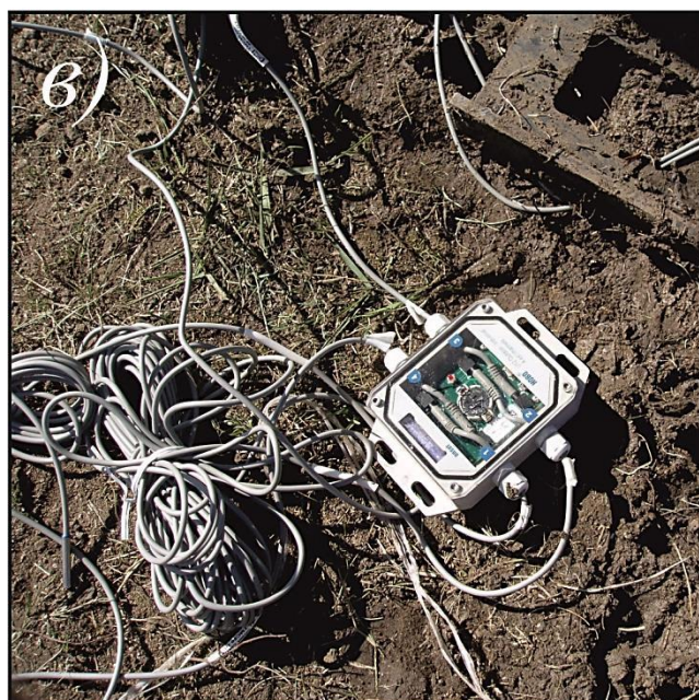
Рис. 6. Логгеры HOBO UA (a), HOBO Pro V2 (b), HOBO U12 (в) и Термокоса (z).
