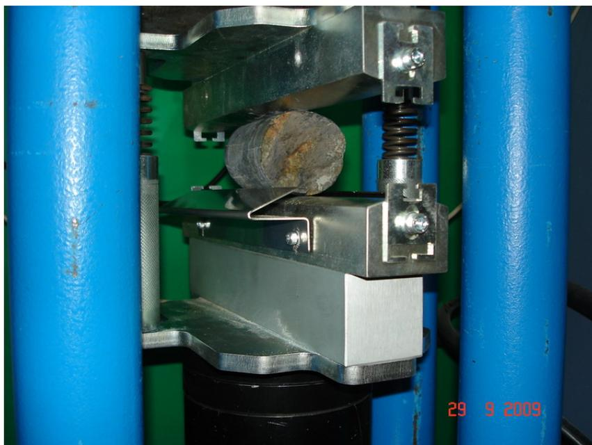
Рис. 11. Фото устройства для определения предела прочности на растяжение.
